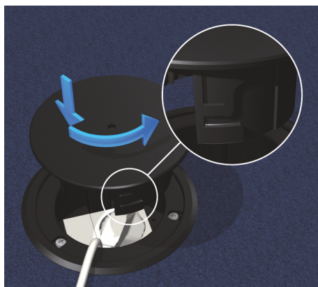
5 | Montaż tubusa Wtyczkę umieścić prawidłowo w gniazdku i nałożyć pokrywę wprowadzając przewód w otwór boczny tubusa. Pokrywę zablokować poprzez umieszczenie jej w otworze kasety oraz obrót w kierunku przeciwnym do kierunku ruchu wskazówek zegara.
