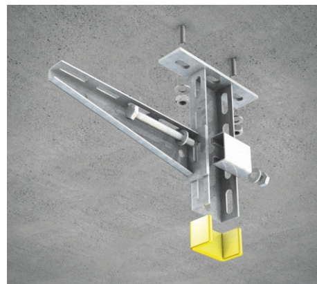
3 | Montaż sufitowy z wspornikiem pionowym KDU 57 Do montażu KDU 57 użyć dwóch kołków, np. SD 10/10*. Wspornik poziomy KW zamocować stosując zestaw KHUSS 40. Opcjonalnie, nakładając od dołu, zabezpieczyć zakończenie kształtownika nakładką ochronną SU 57*.
