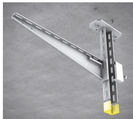
6 | Montaż sufitowy wspornika pionowego KDU 60 Do montażu KDU 60 użyć dwóch kołków, np. SD 10/10*. Wspornik KW zamocować stosując KLS 10x20*. Przy wsporniku dłuższym niż 500 mm, stosować śrubę wraz z elementem dystansowym KHUSS. Opcjonalnie, nakładając od dołu, zabezpieczyć zakończenie kształtownika nakładką ochronną SU 60*.
