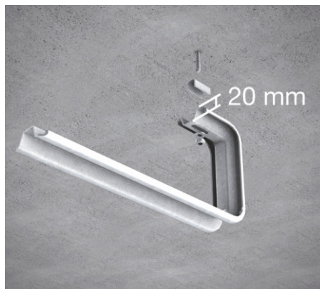
2 | Montaż wspornika DKSL do sufitu Przed montażem, element dystansowy KSL-SP umieścić w prawidłowej pozycji. Do montażu użyć kołka, np. SD 8/30*.
